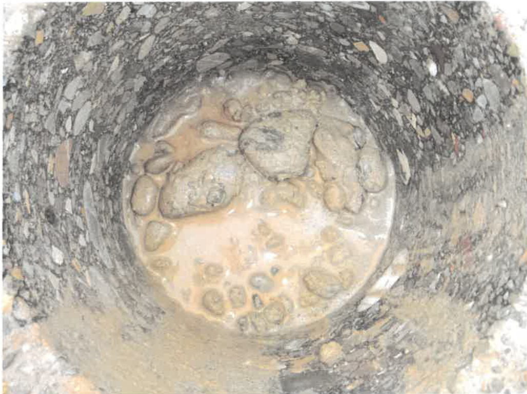
Bild 9 : Bohrloch von Bohrkern N2
